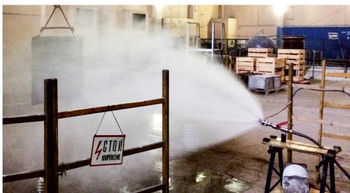
Проверка значений тока утечки по струе распыленной воды при тушении УСПТРВ электрического оборудования, находящегося под напряжением до (6±0.5) кВ.
