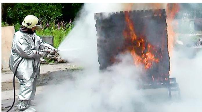
Огневые испытания по тушению модельных очагов пожара класса А.
